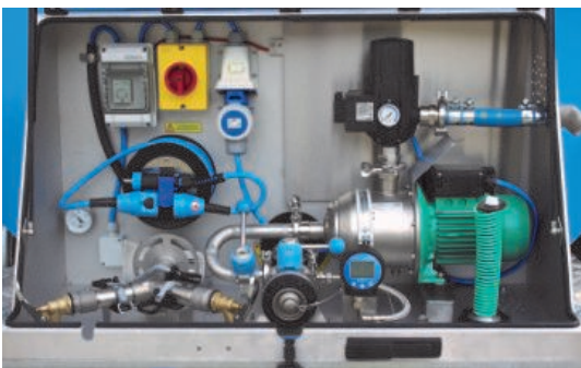
Versorgereinheit mit Pumpe Wilo Medana der MHI, Heizung sowie Druck- und Strömungswächter
