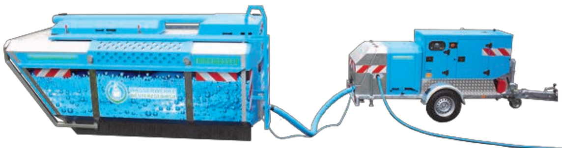
Einsatz einer KTS mit einem Trinkwasser-Absetzbehälter 6m³
